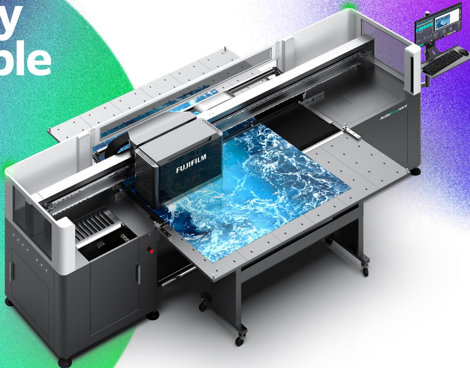
La Acuity Prime Hybrid se puede configurar con hasta 7 canales, con CMYK de serie, y Blanco, Barniz e Imprimación opcional. Además, produce una impresión de gran calidad, capaz de producir tamaños de gotas de hasta 7 pL. Maneja soportes flexibles y rígidos de hasta 51 mm de espesor y soportes en bobina de hasta 2 m de ancho, y aprovecha las ventajas de un sistema de curado UV LED refrigerado por aire muy fiable y duradero.
