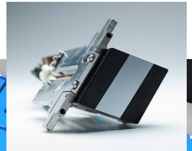
Cabezal de impresión Samba. No visibles a simple vista, las boquillas 2048 están contenidas en el chip de silicio de color plateado que mide solo 44 mm de ancho por 18 mm de profundidad.
