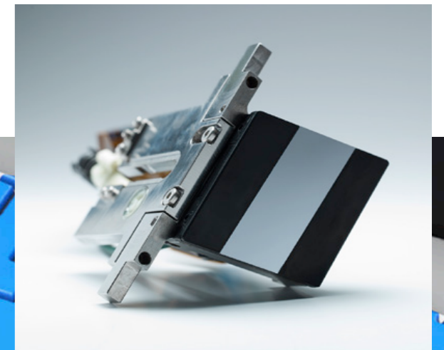
Samba-printkop. De 2048 nozzles zijn niet zichtbaar voor het blote oog en zijn verwerkt in de zilverkleurige siliciumchip die slechts 44 bij 18 mm meet.
