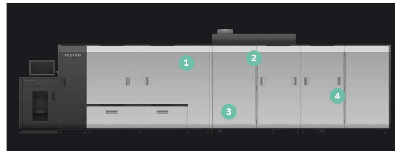
1 Chlazení 2 Fixace 3 Zarovnání soutuisku 4 Proces zobrazování
