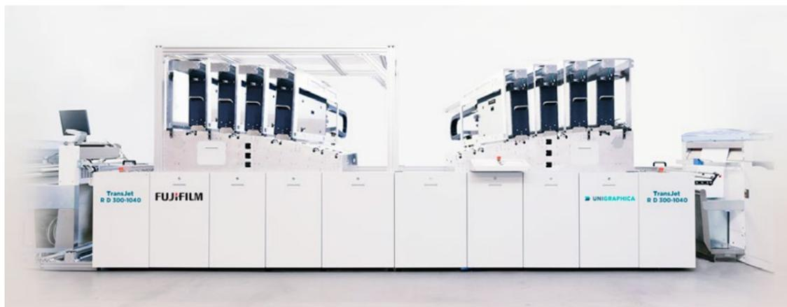
Konfigurierbare Vierfarb-Duplexdruckmaschine von Fujifilm Unigraphics
