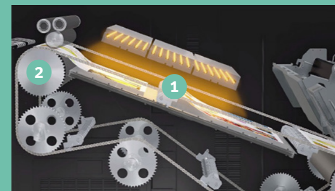
Fusor FIR de bajo desgaste 1 Calentamiento por rayos infrarrojos 2 Rodillo fusor de baja presión
