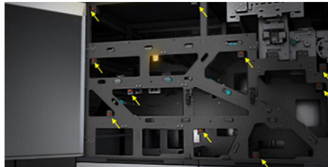
LED de navegación Las luces LED guían al operario hacia las zonas de la prensa que necesitan atención.
