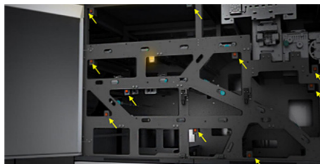
LED de navigation Les voyants LED guident le conducteur vers les zones de la presse qui nécessitent une attention particulière.
