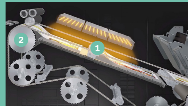
Fusore FIR a sollecitazioni ridotte 1 Riscaldamento a raggi infrarossi lontani 2 Rullo di fusione a bassa pressione
