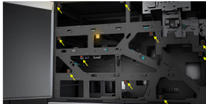
Notificatielampjes LED-lampjes leiden de operator naar het deel van de pers dat aandacht heeft.
