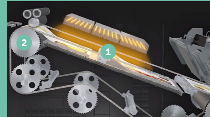
Spanningsarme FIR-fixeerunit 1 Verwarming door straling verre-velinfrarood 2 Spanningsarme fixeerroel
