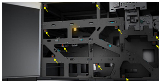
Diody sygnalizacyjne Światła LED kierują operatora do obszarów maszyny, które wymagają uwagi.
