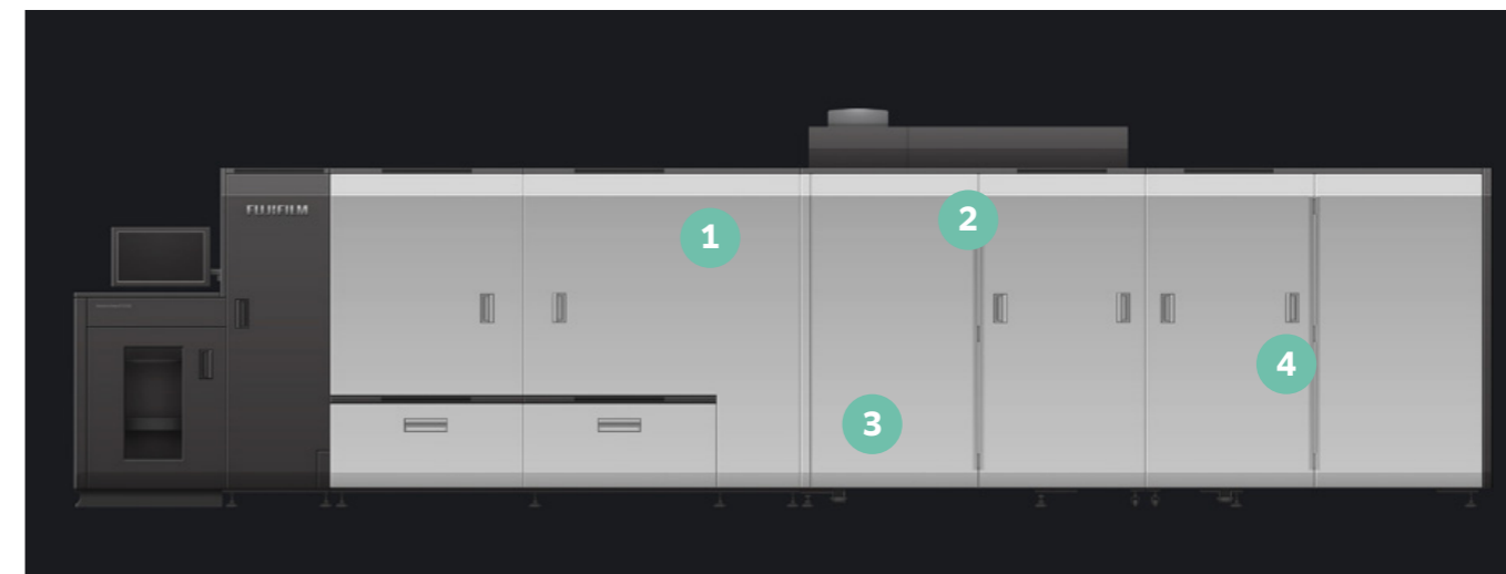
1 Chłodzenie 2 Utrwalanie 3 Wyrównanie pasowania 4 Proces naświetlania
