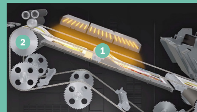
Fusor de baixa pressão FIR 1 Aquecimentos por raios de infravermelhos afastados 2 Rolo fusor de baixa pressão
