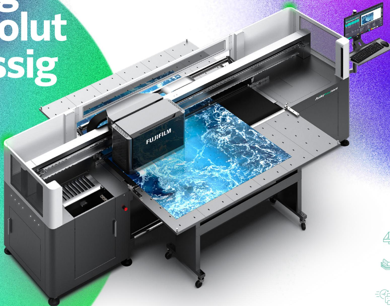
Die Acuity Prime Hybrid kann mit bis zu 7 Kanälen konfiguriert werden: CMYK plus Weiß, Klarlack und Primer als Option. Sie produziert Drucke in hervorragender Qualität mit Tröpfchengrößen von bis zu kleinsten 7 pl. Die Maschine verarbeitet flexible und starre Substrate einer Stärke bis 51 mm sowie Rollensubstrate einer Breite bis 2,1 m und ist mit einem sehr zuverlässigen und langlebigen, luftgekühlten LED-UV-Härtungssystem ausgestattet.
