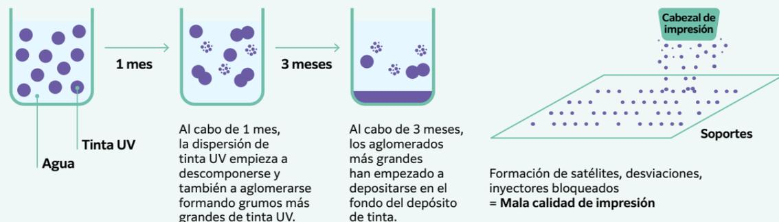
Tintas curables UV a base de agua formuladas mediante la tecnología AQUAFUZE de Fujifilm:
