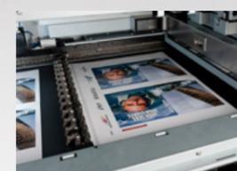
O sistema de secagem inclui uma correia de transporte aquecida através de rolos, com a aplicação de vácuo à folha enquanto passa por esta secção. A secagem é realizada através da correia aquecida e do ar quente aplicado a partir de cima. O vácuo assegura que o calor é aplicado uniformemente, mantendo a folha estável e otimizando o processo de secagem.
