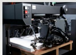
O mecanismo tradicional de alimentação de papel por folha garante uma elevada precisão do registo e um funcionamento fiável.
