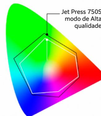
**Uma ampla gama de cores permite a reprodução de imagens vibrantes e permite a correspondência da cor com a norma ISO 12647-2, essencial para ambientes de produção offset e digital mista.**
