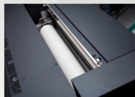
A unidade de preparação aplica uma camada ultra fina de Primário de coagulação rápida ao papel através de um mecanismo de rolo anilox (no modo de Alta qualidade). A reação do primário e da tinta de base aquosa produz pontos incrivelmente nítidos e imagens vibrantes no papel revestido B2 padrão.
