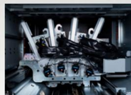
O papel é alimentado para o cilindro de aplicação de imagem, onde se mantém fixo por pinças e vácuo, e quatro barras de impressão Samba depositam as tintas CMYK numa única passagem. O exclusivo sistema de vácuo aumenta significativamente a qualidade e a consistência da impressão.
