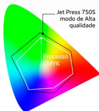
Uma ampla gama de cores permite a reprodução de imagens vibrantes e permite a correspondência da cor com a norma ISO 12647-2, essencial para ambientes de produção offset e digital mista.
