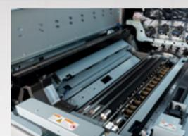
Cada folha é digitalizada pelo Sensor em linha (ILS) com o sistema, implementando quaisquer alterações necessárias em tempo real. O sistema é montado logo após a impressão, para garantir que quaisquer ajustes sejam aplicados dinamicamente durante a tiragem.
