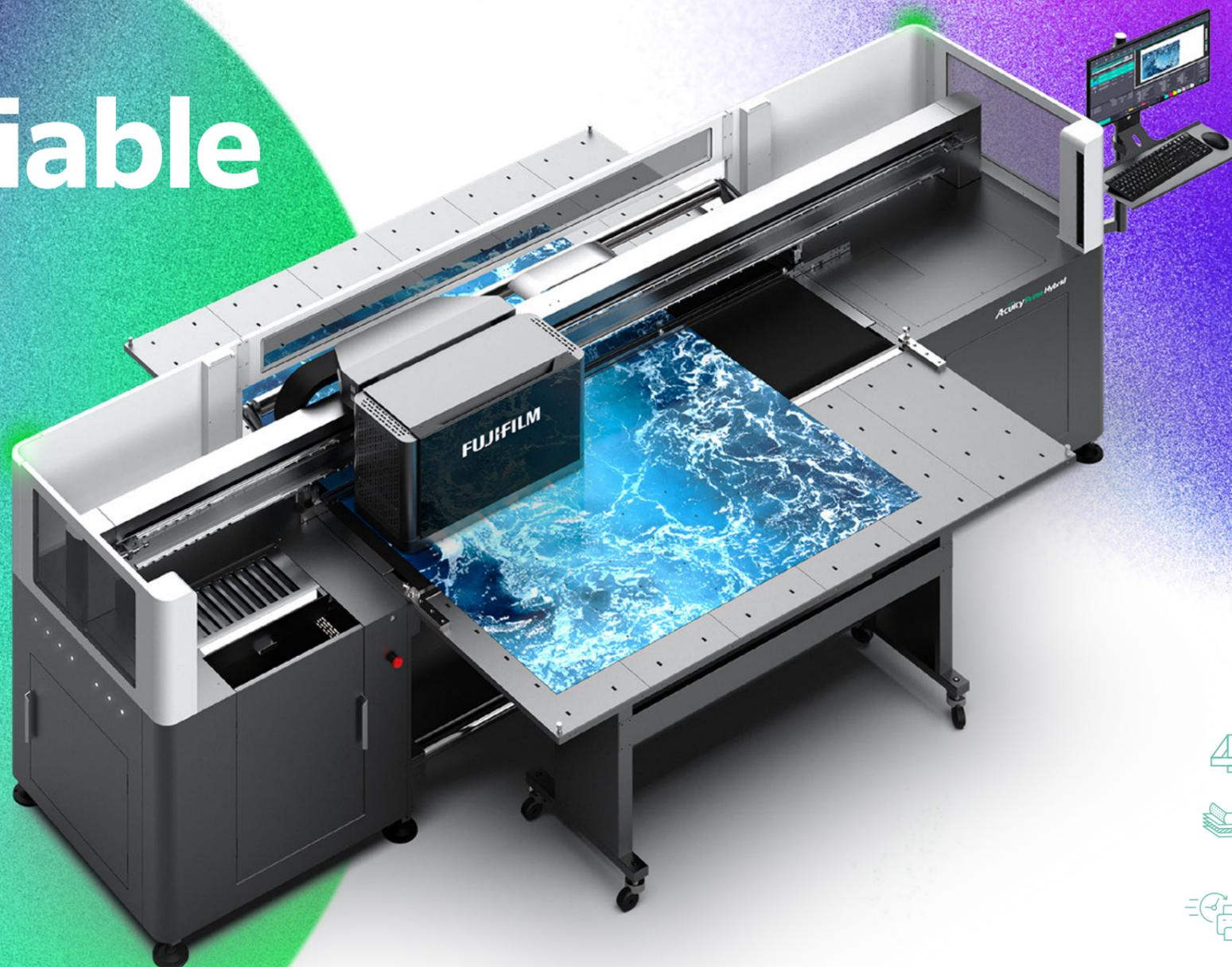
La Acuity Prime Híbrida se puede configurar con hasta 7 canales, con CMYK como estándar, y opcionalmente Blanco, Transparente y Primer, y produce una impresión de calidad impresionante, capaz de producir tamaños de gota de hasta 7 pL. Maneja materiales flexibles y rígidos de hasta 51 mm de grosor, y en rollo de hasta 2.1 m de ancho, y se beneficia de un sistema de curado UV LED refrigerado por aire ultra fiable y de larga duración.
